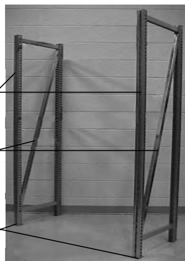
Braces slanted in same direction Los piezas de unión de armazón están en la misma dirección Les entretoises de cadres adjacents sont inclinées dans le même sens
